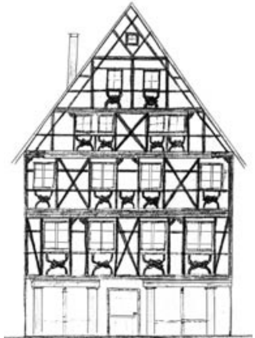
...und Skizze des vermutlichen Zustands des Vorgiebels nach Freilegung des Fachwerks
