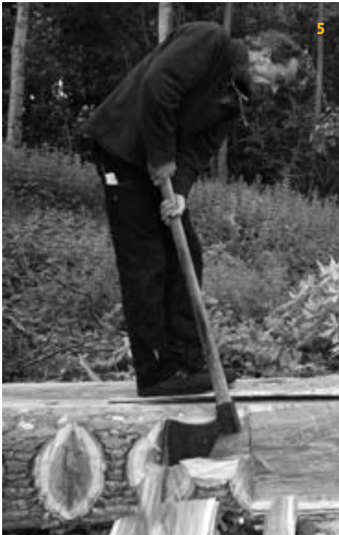
5 Bebeilen eines Balkens mit der Bretonischen Axt (Foto: A. Weller)
